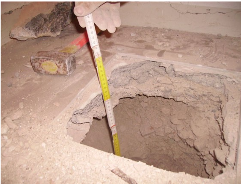
Foto 3 Uno dei due saggi eseguiti nella sala esposizioni che ha evidenziato la presenza della sola cartella di sottofondo appoggiata su di uno strato di livellamento in ghiaietto gettato sopra il materiale inerte di riempimento della volta.
